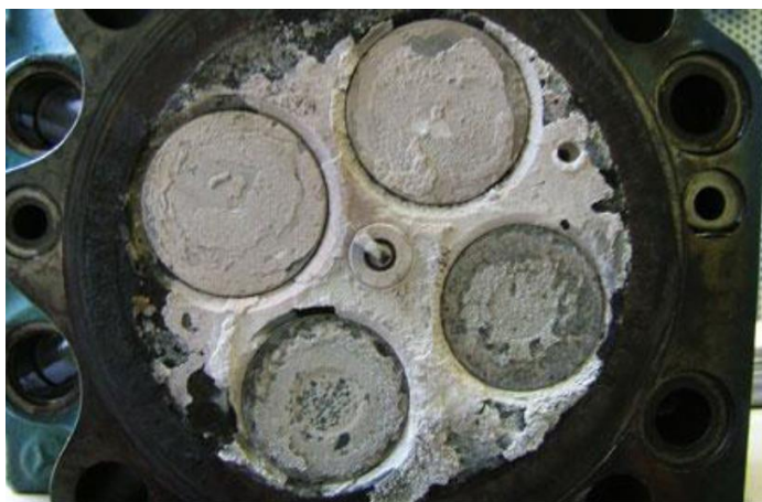
Figura 5 - Pistão danificado devido a presença de siloxanos na combustão Fonte: Evoet, 2018.
